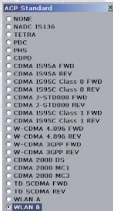
Широкий набор функций R&S®FSL включает измерение мощности в текущем/соседнем канале. Для упрощения работы многие стандартные настройки можно выбирать простым нажатием кнопки
