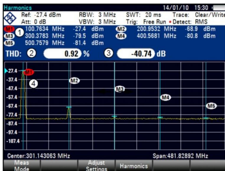
Рисунок 8.8 – Вид экрана при измерении коэффициента нелинейных искажений
