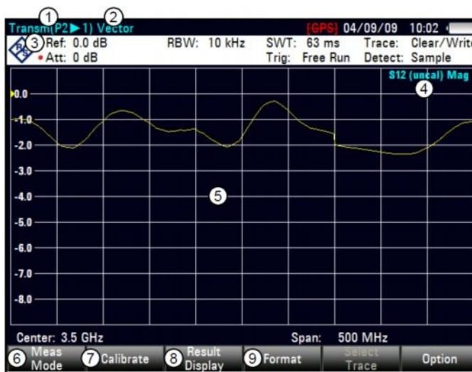
Рисунок 8.10 – Вид экрана при измерении параметров четырехполюсников с помощью следящего генератора
