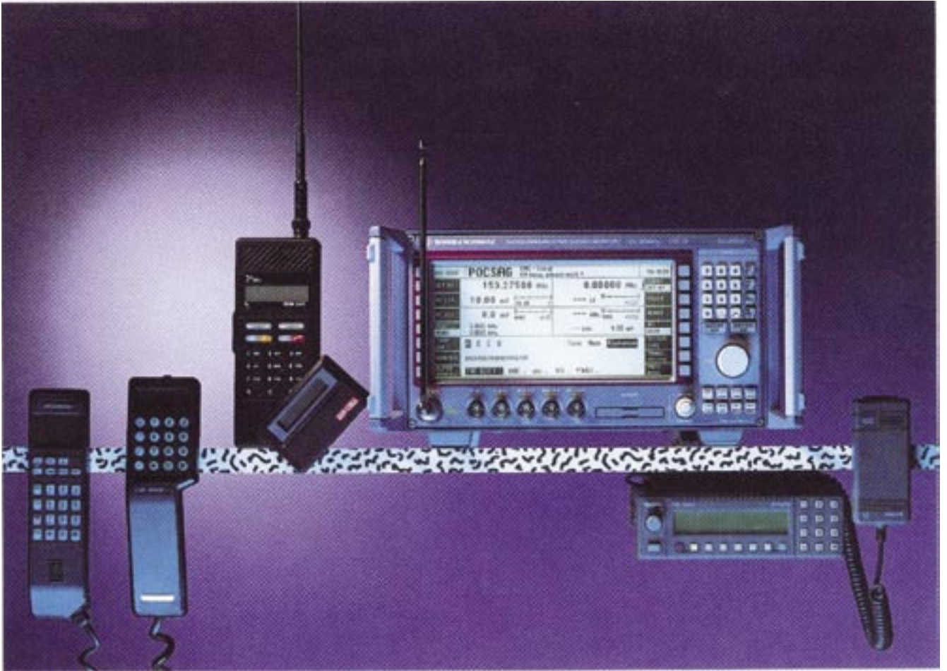
Эргономичный тестер для всех типов радиосвязи: сервисный радиокommunikационный монитор CMS
