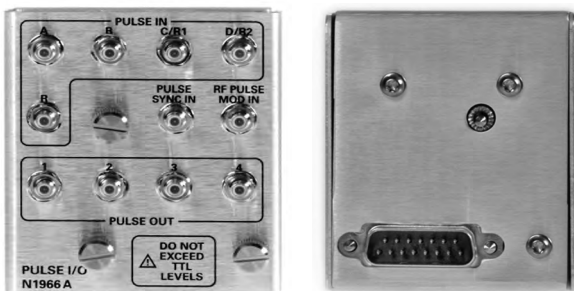
Адаптер ввода-вывода импульсов (N1966A) упрощает подключения.
