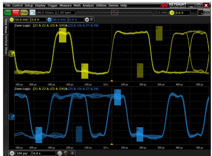
Для запуска по конкретному событию и определенным условиям нарисуйте на экране до восьми зон типа «должно пересечь» или «не должно пересечь».
