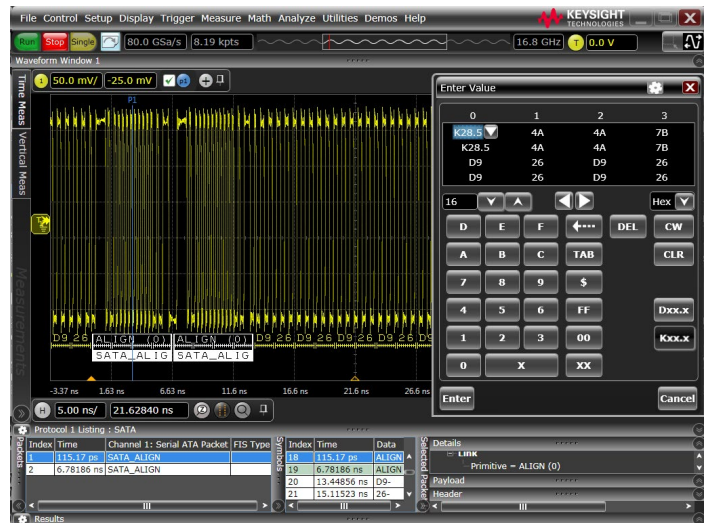
Выполняется аппаратный запуск осциллографа серии V по символам "K" и "D" кодов сигнала SATA. Затем программный декодер протокола преобразует символы в пакеты данных более высокого уровня, такие как пакеты SATA ALIGN.
