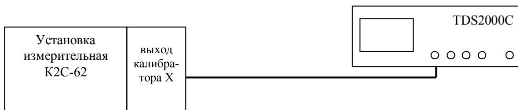
Рисунок 3– Схема определения диапазона установки коэффициентов развертки и погрешности частоты опорного генератора
