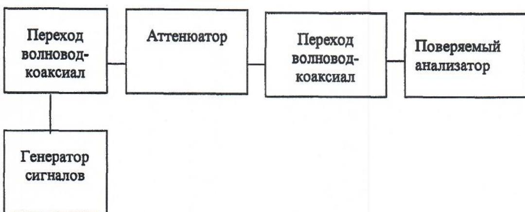
Рис. 2. Схема для определения погрешности измерения уровня мощности в динамическом диапазоне.
