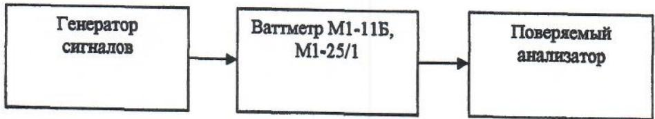
Рис.3. Схема для определения погрешности измерения уровня мощности 1 мВт в диапазонах 18 – 37,5 ГГц и 37,5 - 50,0 ГГц.
